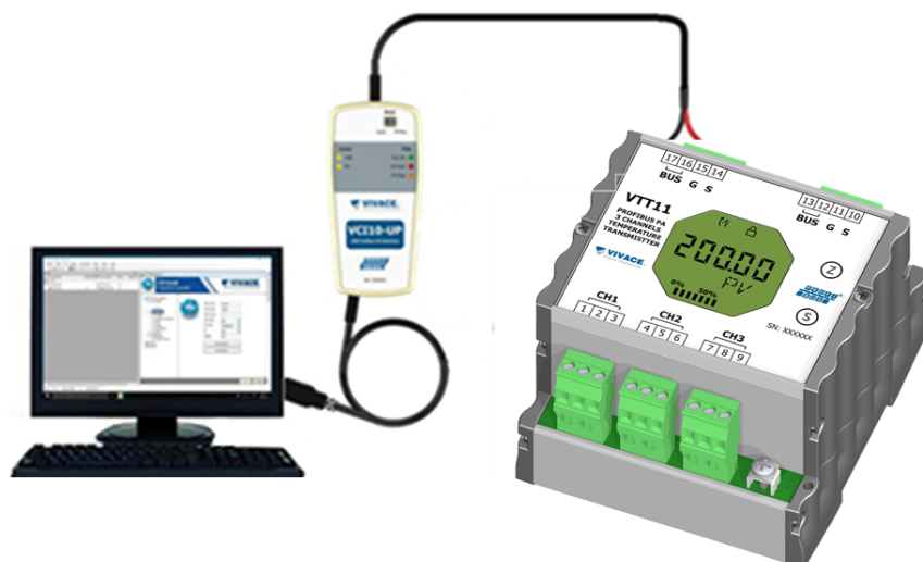
Figura 3.5 – Esquema de configuração do VTT11-PP com a VCI10-UP.
